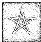
3:2, αντίθετο πλάτος, αντίστροφη κίνηση
